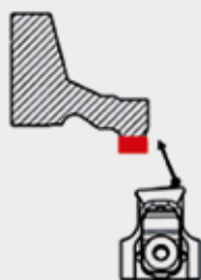
Plongée progressive dans l'angle
